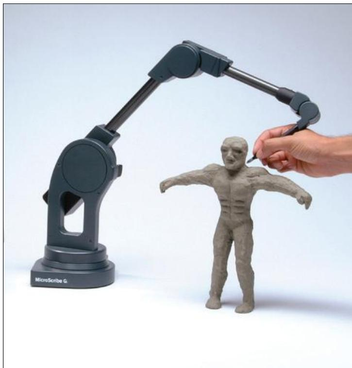
Рис. 1. Общий вид дигитайзера при измерении поверхности фигурки. Оператор с помощью щупа последовательно замеряет координаты её поверхности, которые фиксируются в компьютере.
