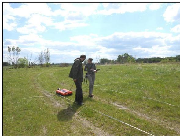
*Рис. 9 и 10. Площадная георадарная съемка. Весна 2017 года*
